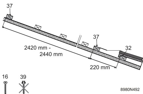
**i** Utilice los tornillos 6x70 (16) para fijar los listones de montaje. No utilice tornillos estancos (39).
