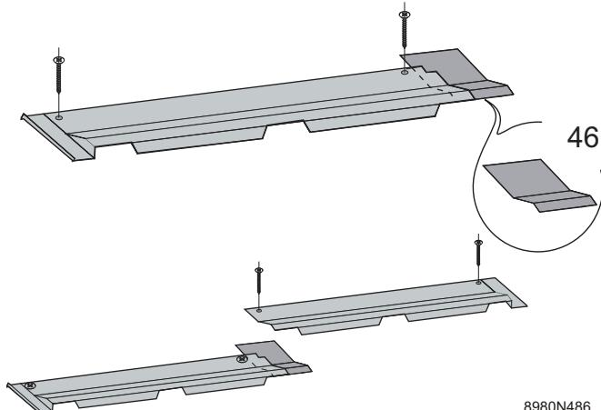
Controleer de stand van de TRS links (33-A) en zet deze daarna vast op de montagelat (37) met behulp van een 2e schroef 3,9 x 25 mm (45).
