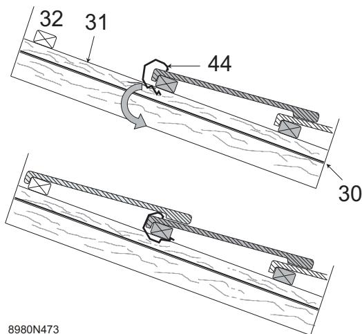
In voorkomende gevallen kan het nodig zijn de rechter rij dakpannen af te snijden. Verwijder de ophanghaken aan de kant van de plaat in de rijen dakpannen bij het dakinbouwmontagesysteem.
