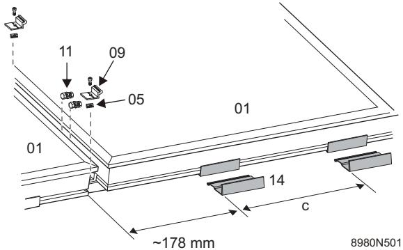
Plaats een ankerblok (05) in elk basisprofiel (04) en positioneer ze zo dat de klembeugels (09) van het tweede zonnepaneel kunnen worden vastgezet tegen die van het eerste zonnepaneel.
