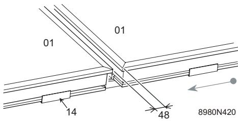
Ajuste la posición del captador plano de manera que las patas de fijación estén alineadas con los bordes izquierdos de los perfiles base. Monte las patas de fijación en los perfiles base con un tornillo hexagonal atornillado a los calzos de corredera.
