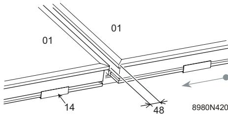
Stel de stand van het vlakke zonnepaneel zo af dat de klembeugels in lijn liggen met de linker uiteinden van de basisprofielen. Zet de klembeugels vast op de basisprofielen met behulp van een inbusbout in de ankerblokken.
