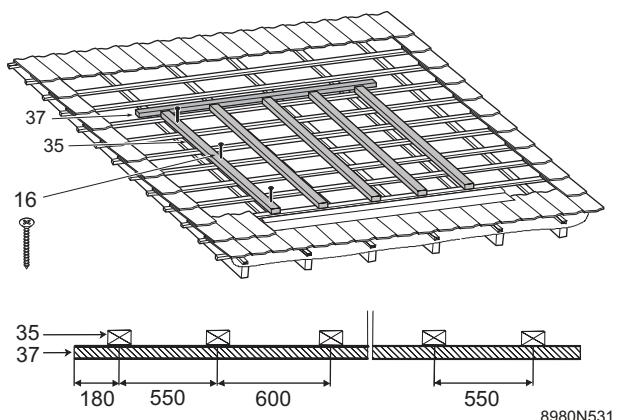
8. Para la posición vertical de los tableros de montaje, siga las indicaciones de la siguiente figura.
