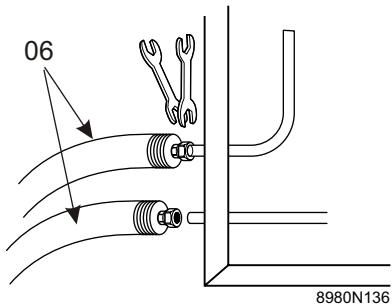
**⚠ Prestare particolare attenzione ai raccordi bicono durante il fissaggio per non danneggiare i raccordi del pannello.**
