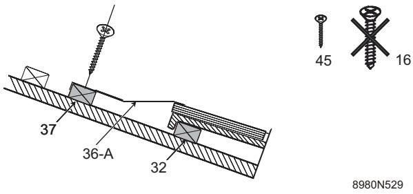
Zet de TRI links vast op de montagelat (37) met behulp van de kleine schroeven 3.9x25 (45).
