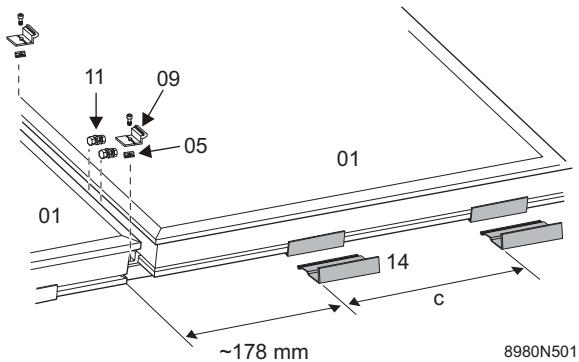
Posizionare un blocchetto di ancoraggio (05) in ciascun binario di base (04) e posizionarlo in modo che le staffe di fissaggio (09) del secondo pannello possano successivamente essere fissate contro quelle del primo.
