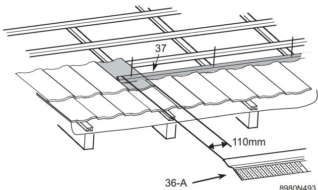
Vuelva a colocar la última teja (abajo a la izquierda) y marque el lado derecho de la misma en el listón inferior (37). Retire la teja. Véase figura 8980N493.
