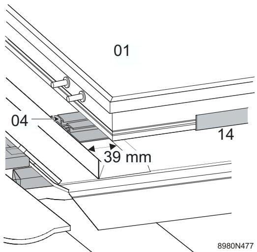
Demonteer de handgrepen van het eerste zonnepaneel en zet ze op het tweede zonnepaneel.
