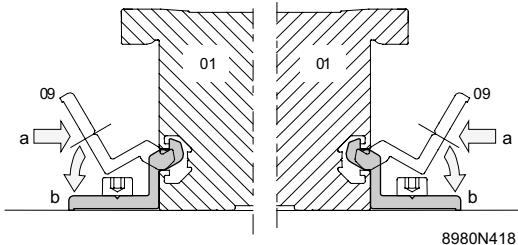
**! Compruebe que coincidan las conexiones. Encaje cuidadosamente el captador en las conexiones bicono.**
