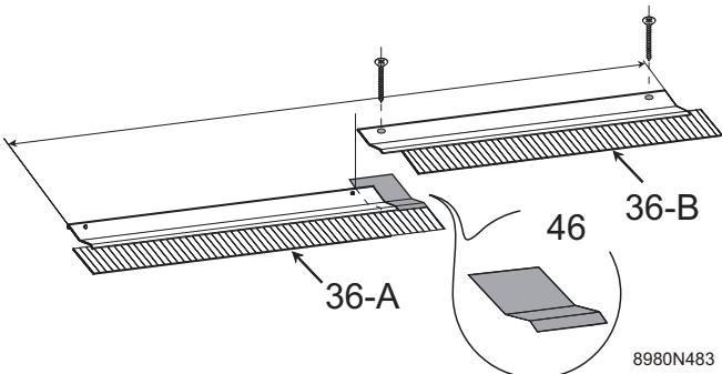
Marque el extremo izquierdo en la CRI de la izquierda, retire la película protectora de la cinta de butilo de la CRI de la derecha y vuelva a colocar la CRI.
