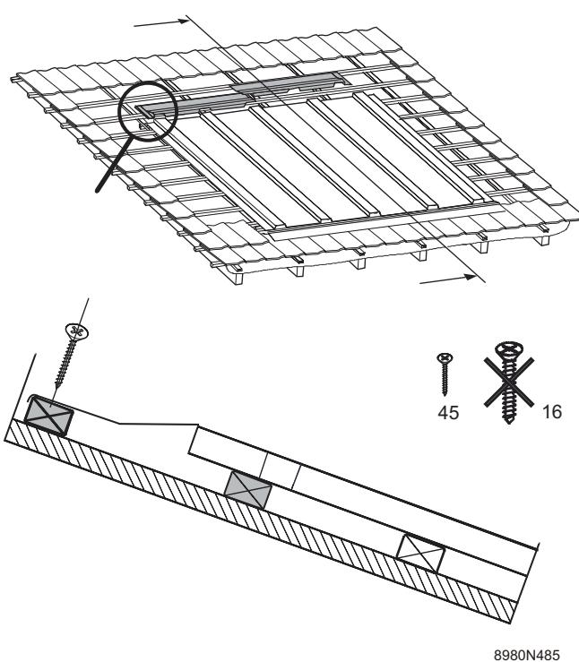
15. Schuif het loden onderdeel (46) half onder de rechterraand van de TRS. Het onderste deel moet op gelijke hoogte liggen met het loden schutblad van de TRS. Het bovenste deel moet tegen de montagelat liggen.
