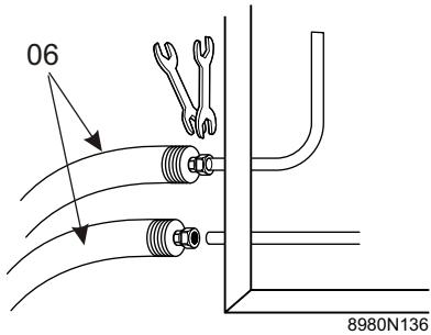
**⚠ Sujete firmemente las conexiones bicono durante la fijación para no dañar las conexiones del captador.**
