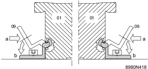
Regolare la posizione del pannello piano in modo che le staffe di fissaggio risultino allineate con le estremità di sinistra dei binari di base. Fissare le staffe di fissaggio ai binari di base servendosi di una vite femmina a testa esagonale avvitata nei blocchetti di ancoraggio.
