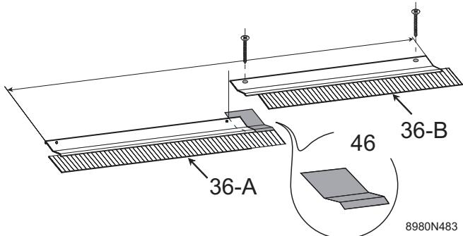
Markeer het linker uiteinde op de TRI links, verwijder de beschermfilm van het butyltape van de TRI rechts en plaats de TRI terug.
