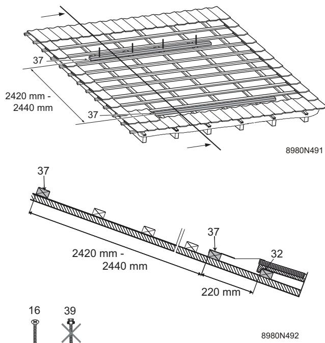
**i** Utilizzate le viti 6x70 (16) per fissare i listelli di montaggio. Non utilizzare viti a tenuta stagna (39).
