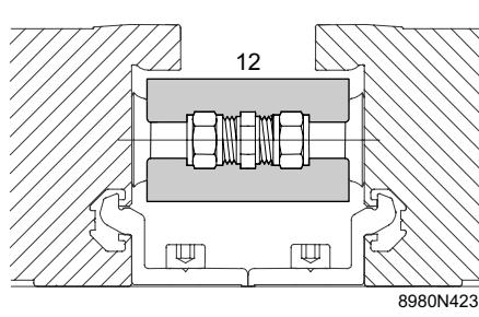
Isoleer de andere hydraulische verbindingen op dezelfde manier.
