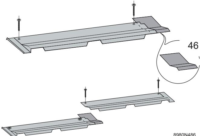
Verificare l'orientamento della TRS di sinistra (33-A), quindi fissarla sul listello di montaggio (37) mediante una seconda vite 3,9 x 25 mm (45).
