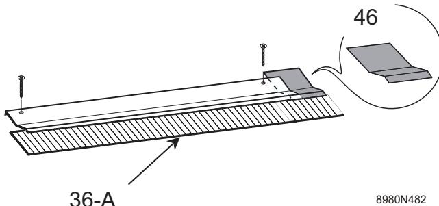
Verificate l'orientamento della TRI sinistra (36-A) e fissatela poi sul listello di montaggio (37) per mezzo di una seconda vite 3,9 x 25 mm (45).
