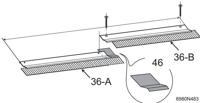
Trovate l'estremità sinistra sulla TRI di sinistra, rimuovete il film di protezione del nastro di butile della TRI di destra e riposizionate la TRI.
