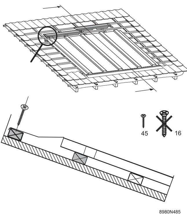
**15.** Far scivolare la parte in piombo (46) a metà sotto il bordo dritto della TRS. La parte inferiore deve posizionarsi allo stesso livello del grembiule di protezione in piombo della TRS. La parte superiore deve posizionarsi contro il listello di montaggio.
