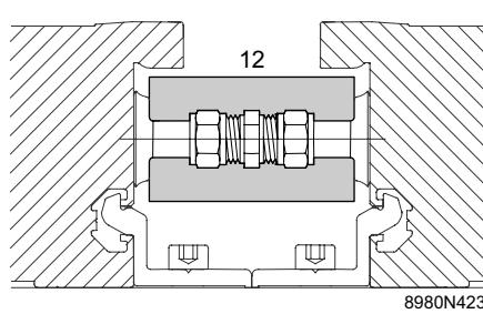
Isolare gli altri collegamenti idraulici nello stesso modo.
