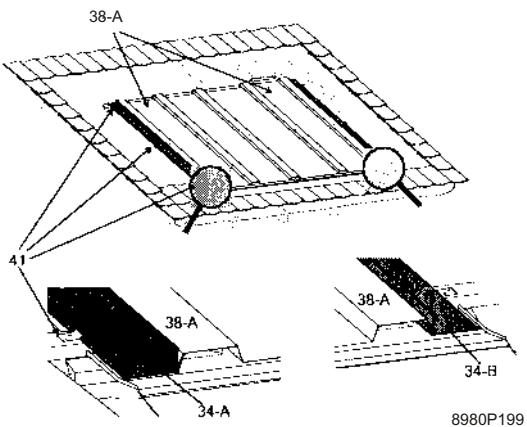
**14.** Posare la lamiera di copertura superiore (TRS) sinistra (33-A) sulle vasche (38-A e 38-B) e sulla TRL allineandola a sinistra e farla scivolare verso il basso, in modo che il suo spigolo sia ben fermo contro il listello di montaggio (37). Fissare sul listello di montaggio servendosi di una vite piccola (45).
