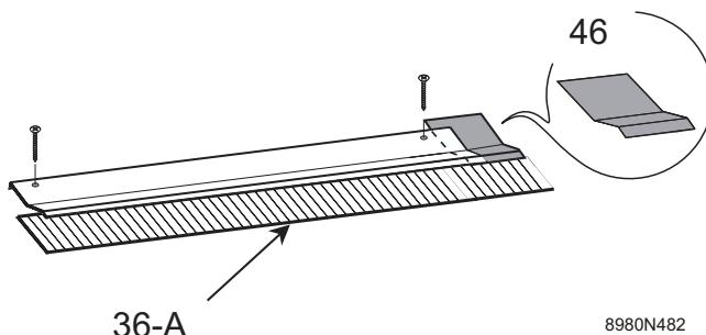
Compruebe la orientación de la CRI izquierda (36-A) y fíjela al listón de montaje (37) con un segundo tornillo 3,9 x 25 mm (45).
